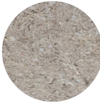
Fig 8 Compósito lightwood cor azul com a face lixada
